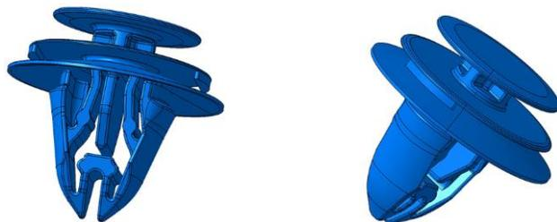
(備考)本品は逆パンチ穴専用品です。順パンチに使用すると、ボディ板裏側のバリに係止爪が引っ掛かり抜去力が大きく上昇、クリップが外れる際には脚部が破壊するのでご注意ください。クリップの取り外しをしない、あるいは取り外しの際に上記の破壊があっても問題ない要件であれば、順パンチ穴に使用可能です。その場合は低挿入力を特徴としたクリップとして利用できます。
